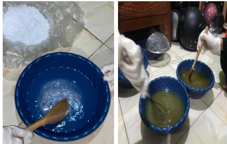
Gambar 5. Melarutkan NaOH Dengan Air Dan Mencampurnya Ke Dalam Minyak
